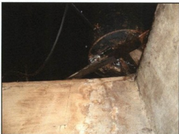
Detalhe do tambor metálico de armazenamento de água de uma das casas, já oxidado e com vazamento.
