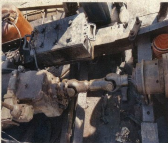
Draga interdita: Manômetro ilegível, eixo cardã desprotegido, piso escorregadio, EPI compartilhado, faltava a linha de vida.
