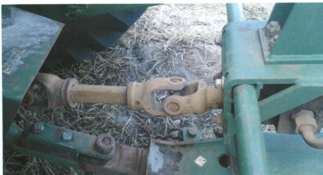
Foto 03: acoplamento de implemento ao eixo cardã sem proteção.
