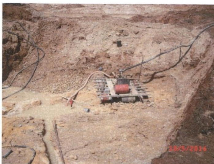
Baixão onde os garimpeiros trabalham. Observar o paredão sem a utilização de talude para estabilizar o maciço.
