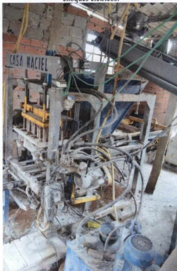
09.12.2015 – Máquina de fazer blocos com ligações elétricas totalmente improvisadas, com risco grave e iminente de choques elétricos.
