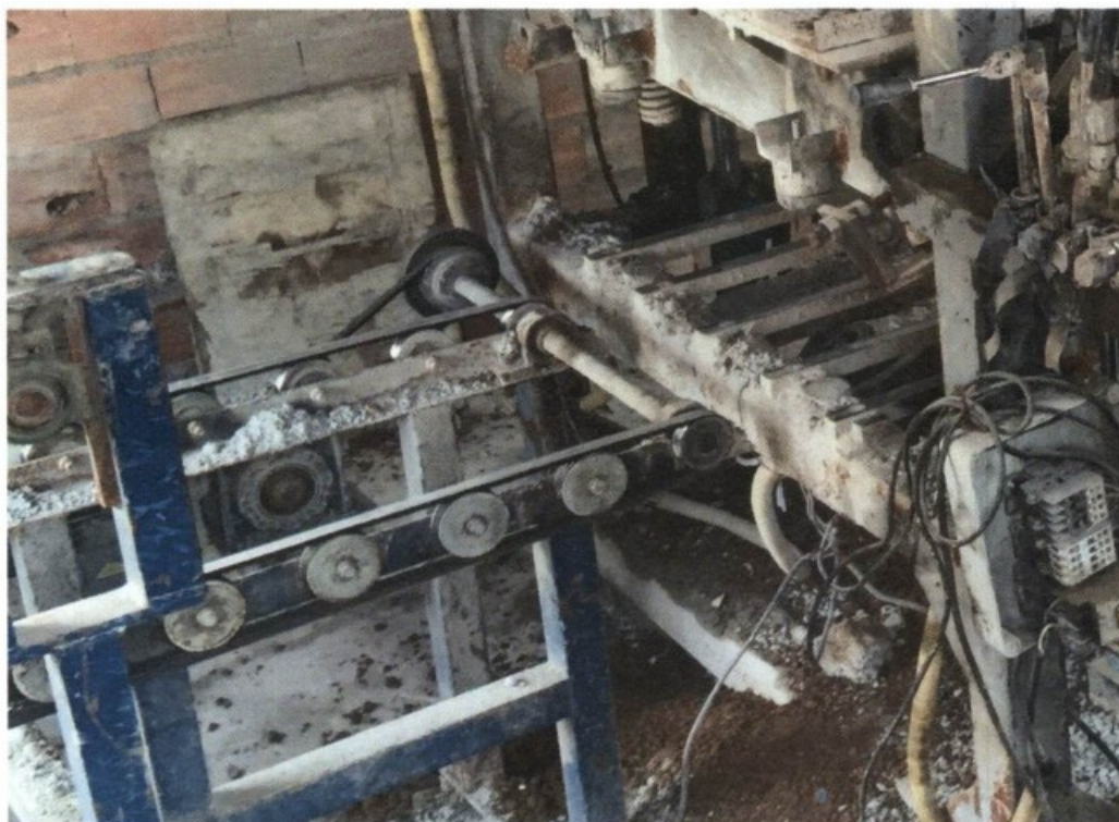
09.12.2015 – Correias e polias sem proteção fixa ou proteção móvel intertravada. Risco de acidentes.
