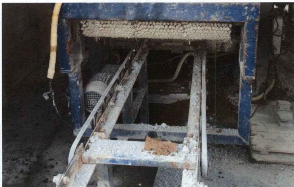
09.12.2015 – Correias e polias sem proteção fixa ou proteção móvel intertravada. Risco de acidentes.
