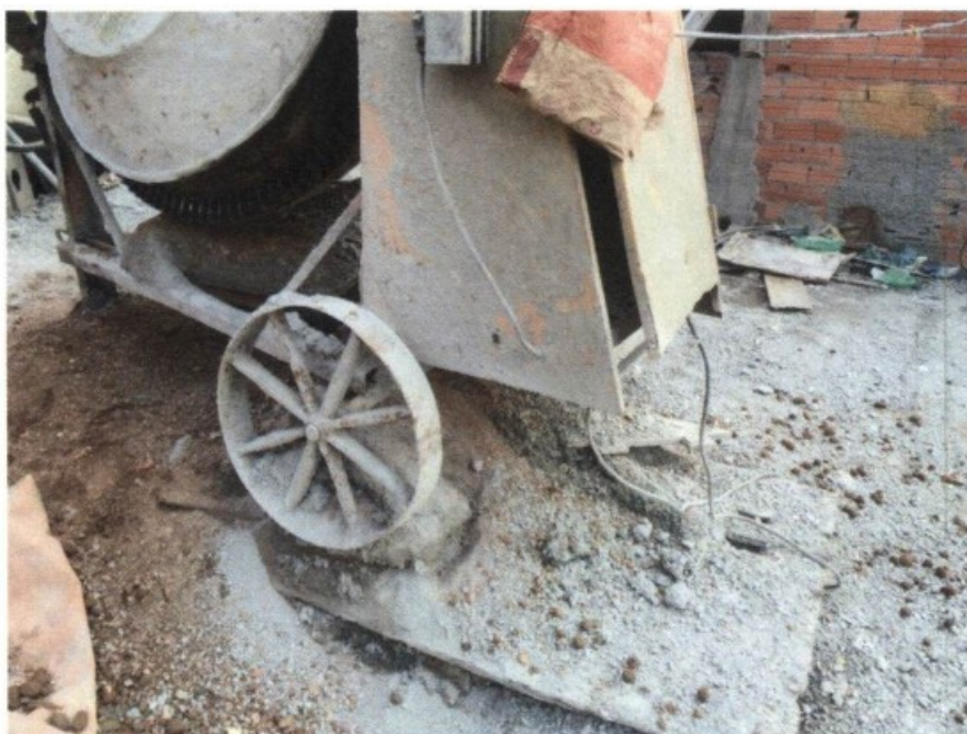
09.12.2015 – Betoneira com ligações irregulares, fios expostos e sem aterramento. Risco de choques elétricos.
