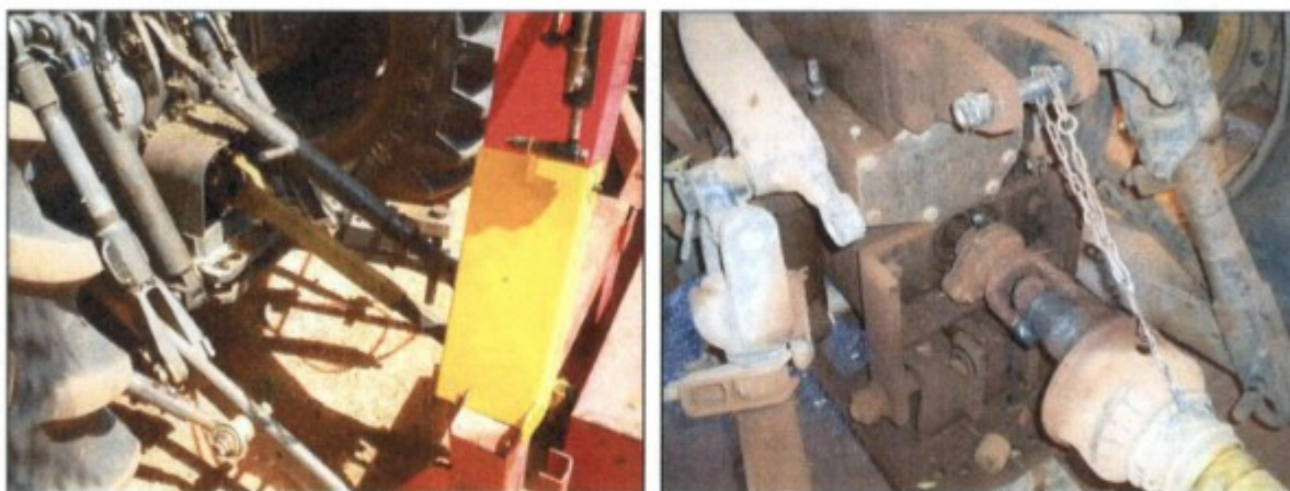
Fotos: Eixos cardã dos tratores desprotegidos.
