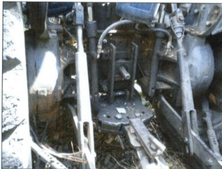
Foto: Eixo cardã do trator desprotegido.
