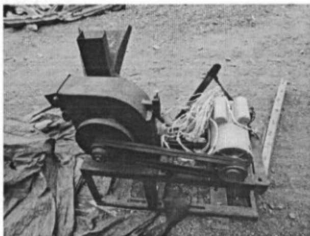
Foto 40: Máquina forrageira, transmissões de força desprotegidas.
