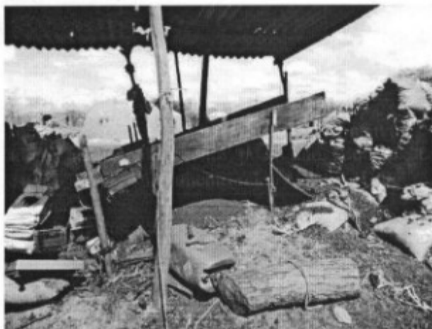
Foto 32: Máquina separadora/peneiradora de carvão, sem aterramento.
