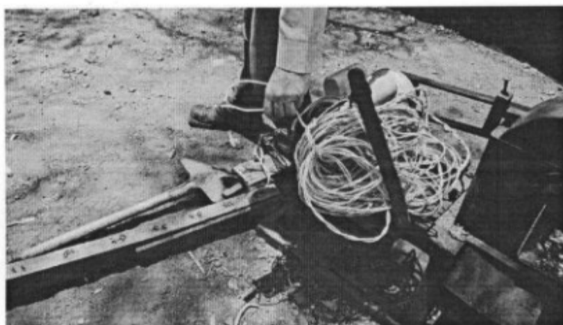
Foto 39: Máquina forrageira, sem aterramento, irregularidades na parte elétrica, fios com extremidades soltas e sem plug.
