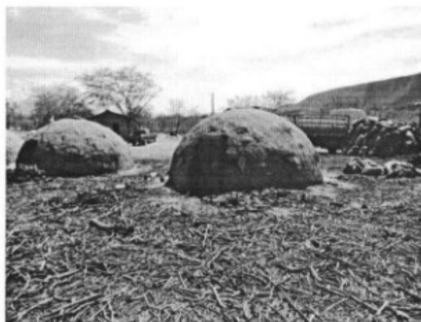
Foto 11: Forno de produção de carvão, com madeira, já fechado.
