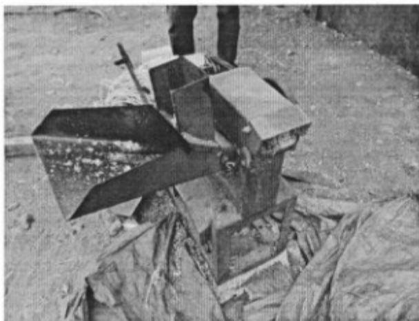
Foto 37: Máquina forrageira, sem aterramento, sem sistema de proteção na zona de perigo.
