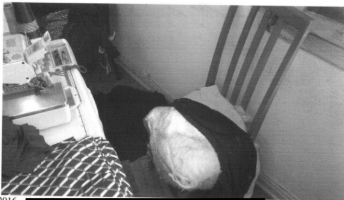
21/09/2016 – [REDACTED] - assentos improvisados dos postos de trabalho, em desconformidade com a NR 17.
