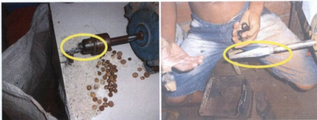
Fotos 17 e 18 – à esq., perfurador de sementes de açaí; à dir., lixador de anéis de sementes de Tucum; Blocos conectadas a eixos de motores elétricos, sendo que o resultado do trabalho consiste na ação da ferramenta sobre as sementes em decorrência do movimento em alta rotação.
