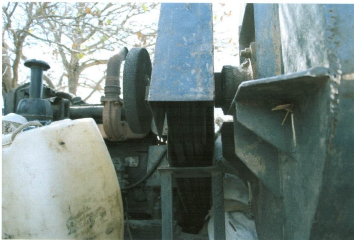
Foto 15: Máquina de separar a palha do pó da carnaúba. Transmissão de força exposta.
