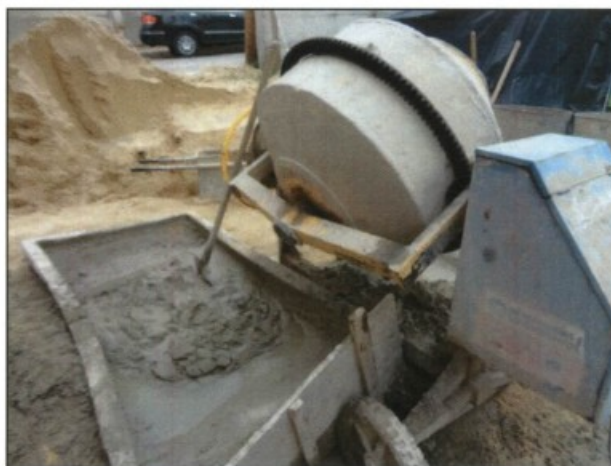
Parte posterior da betoneira, com vista da cremalheira desprotegida.
