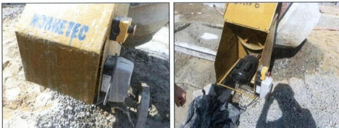
Fotos: Betoneira que era utilizada no canteiro da obra, com transmissões de força expostas.
