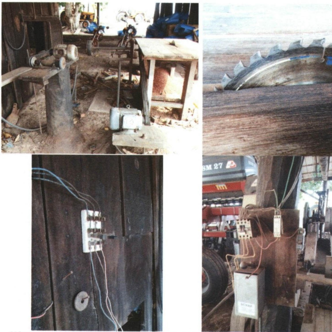
Máquinas desprotegidas, acionamento por meio de chave faca e ausência de dispositivos de parada de emergência.
