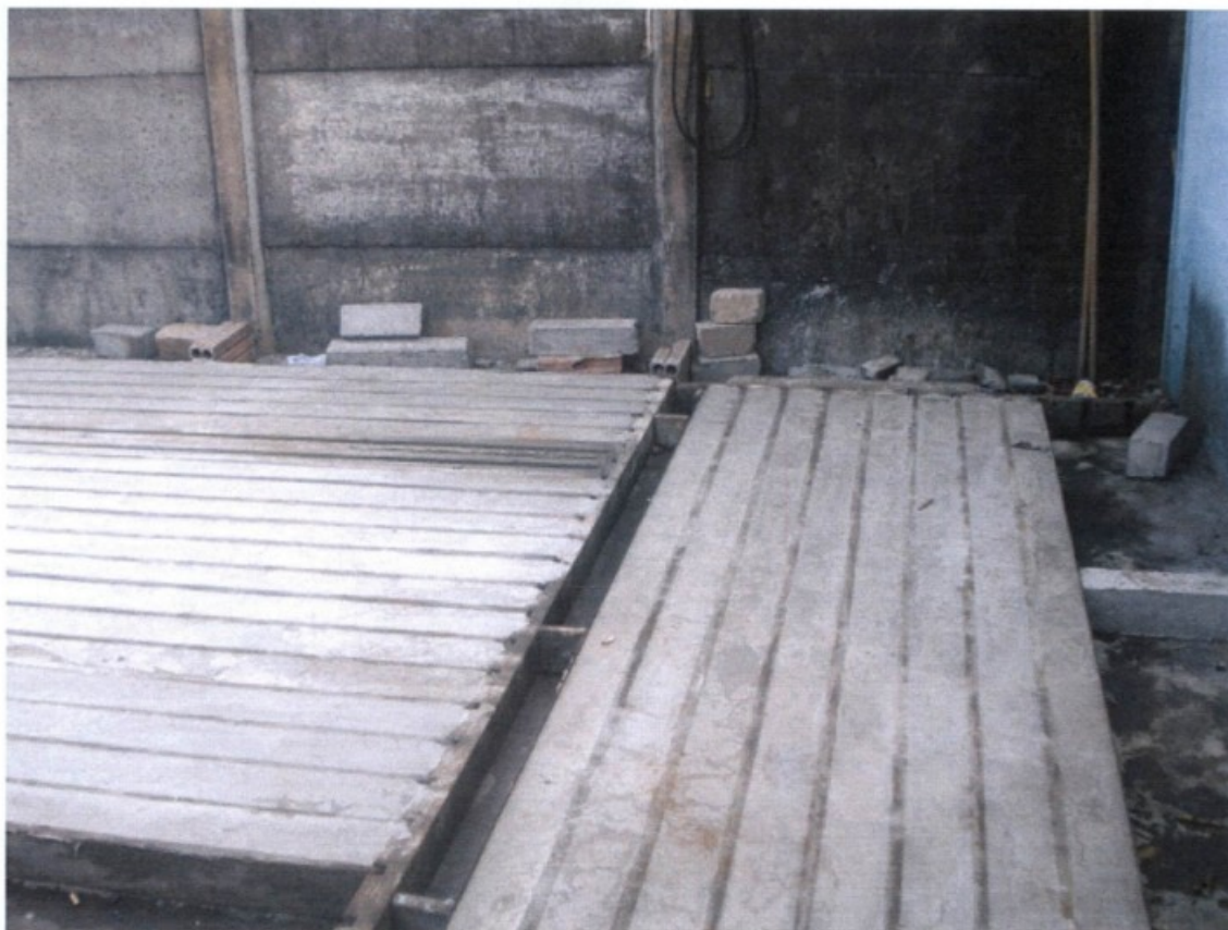
Foto 8- Pré-moldado de canaletas para meio-fio
