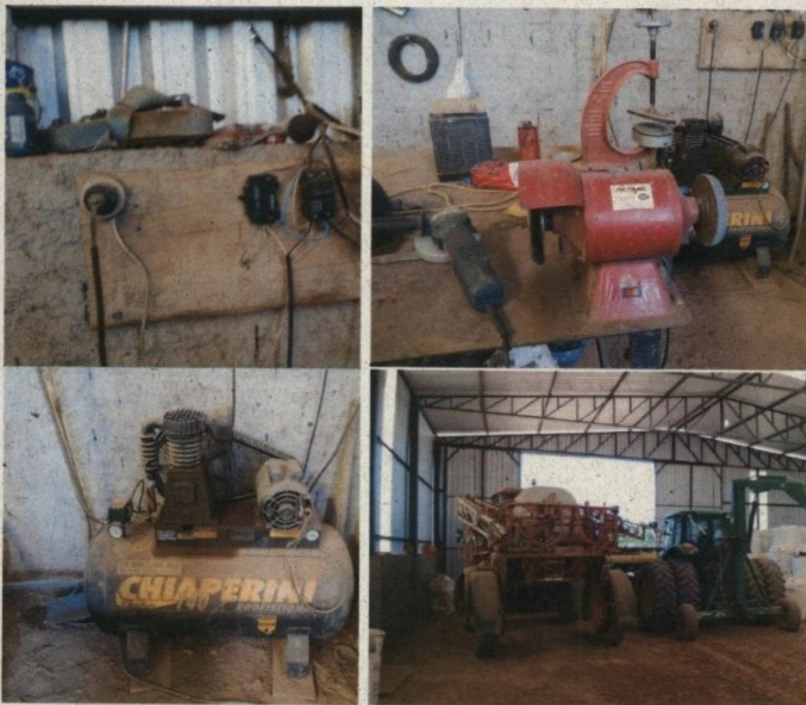
No galpão eram mantidas diversas máquinas, algumas com partes perigosas desprotegidas, e parte da fiação também desprotegida.
