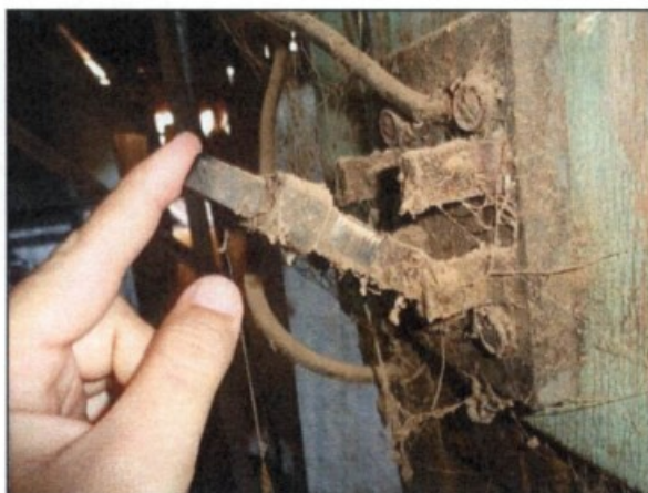
Fotos: Instalações elétricas das máquinas, apresentando riscos de choques e outros acidentes.
