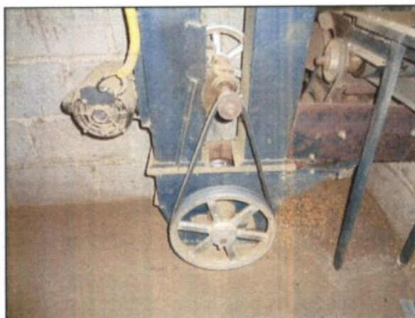
Fotos: Transmissões de força das máquinas expostas.
