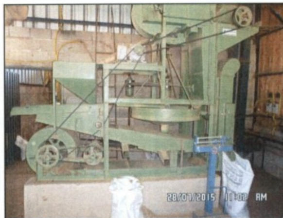
Fotos: Transmissões de força das máquinas expostas.
