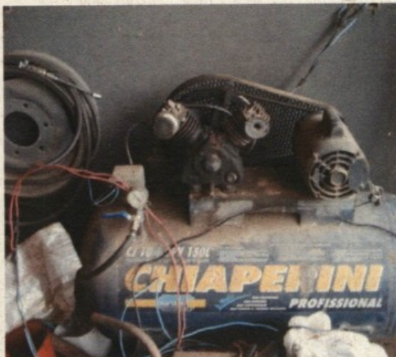
Compressor ligado diretamente à fiação, sem plugues ou tomadas.
