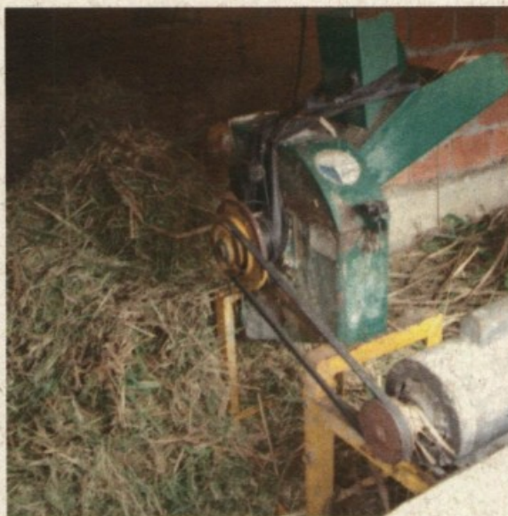
Disjuntor pendurado pelo próprio fio para ligar a máquina diretamente.
