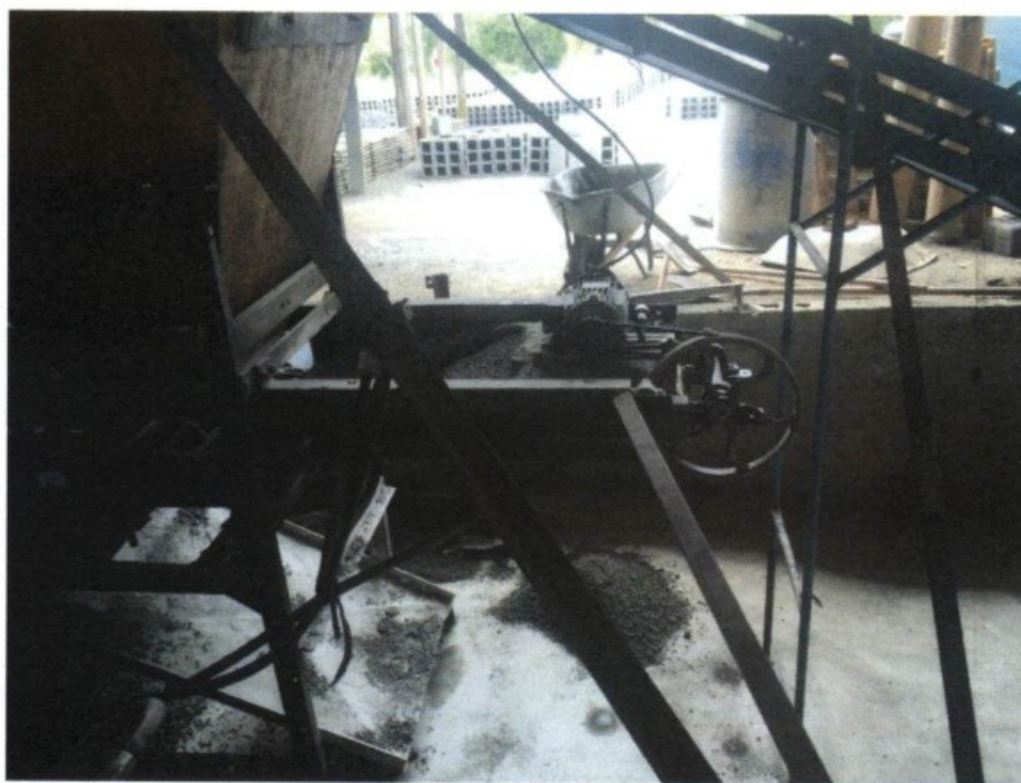
14.09.2015 – Falta de proteção fixa e/ou proteção móvel intertravada nas transmissões de força, como correias e polias.
