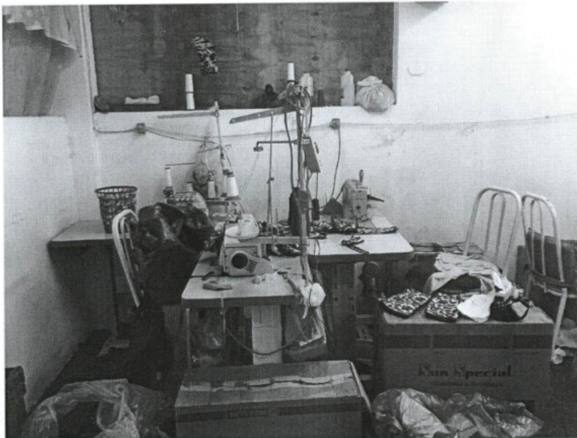
máquinas sem proteção de polias e correias de transmissão.
