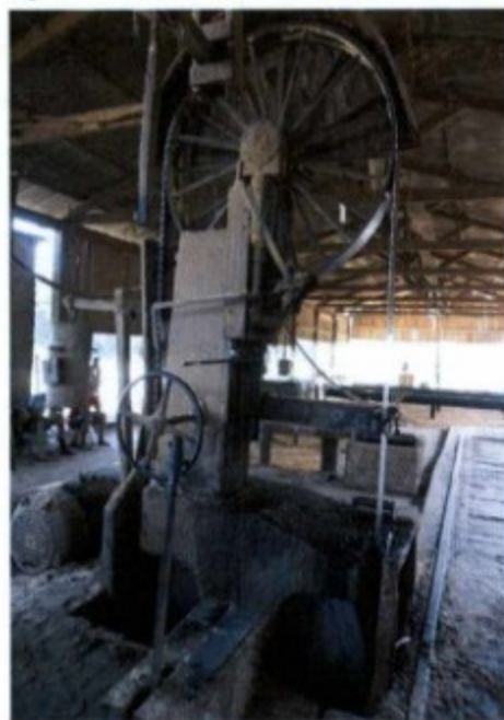
1: Serra Fita sem proteção na sua zona de perigo.
