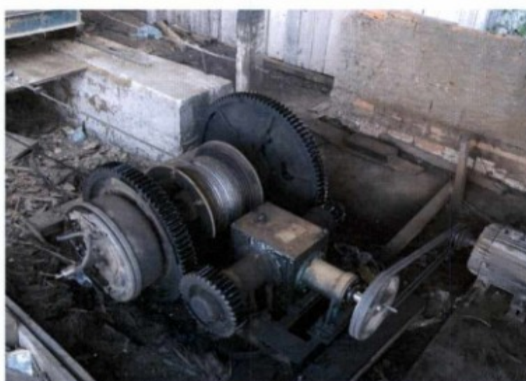
Fig. 3: Detalhe do tambor do eixo do carrinho desprotegido.
