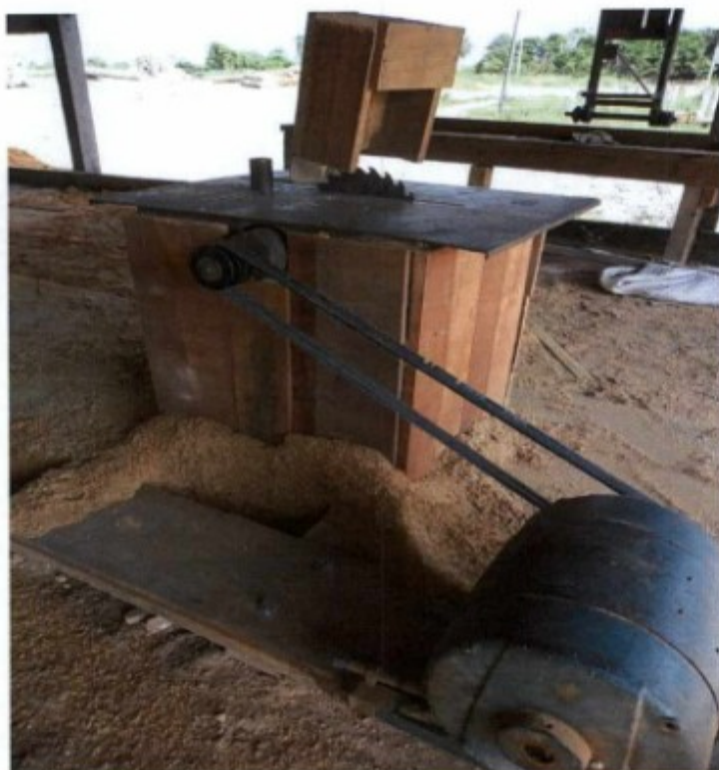
Fig. 5: Polia do motor da serra circular desprotegida.
