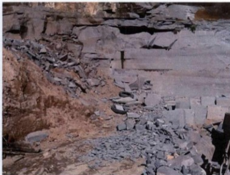
Ausência de meios de acesso para os postos de trabalho, ocasionando risco de quedas e ferimentos
