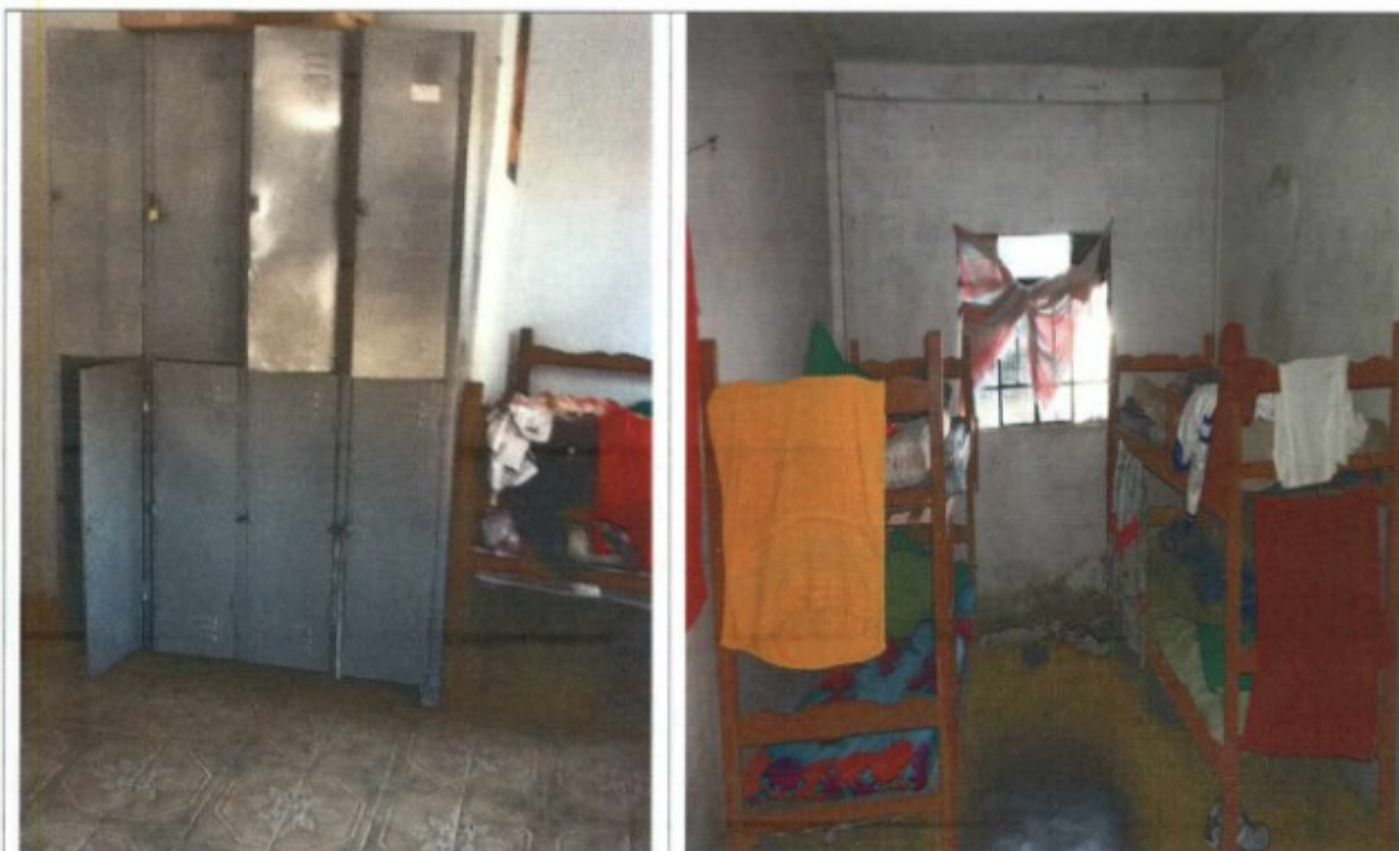
Foto 08: Armários individuais com dimensões inferiores às previstas no item 18.4.2.10.7 da NR-18.
