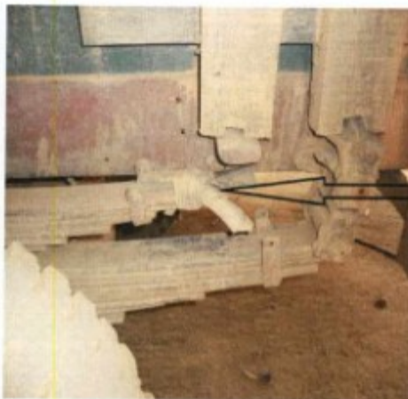
FEIXE DE MOLAS DA RODA TRASEIRA ESQUERDA PRESA COM LIGA DE BORRACHA
