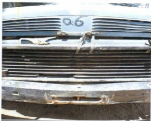
Capô do Caminhão amarrado com liga de Borracha.
