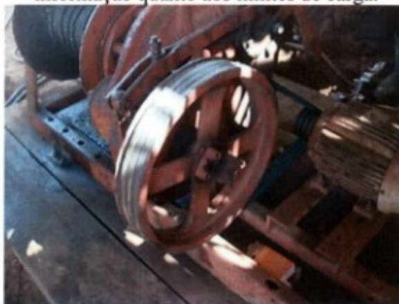
Transmissão de força do motor exposta.
