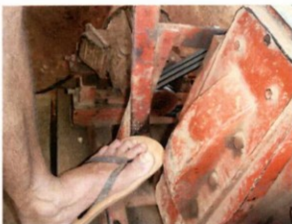
Dispositivo de freio próximo a partes móveis do motor.
