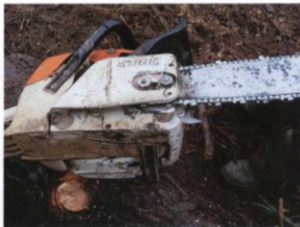
Trabalhador operando motosserra sem dispositivo de segurança.
