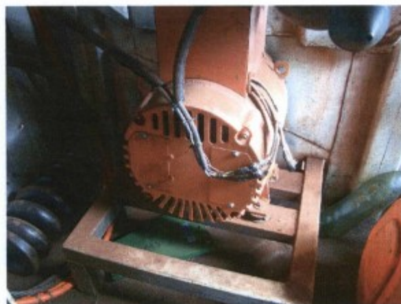
Foto 1- Fiação elétrica não acondiciona em eletroduto-fiação exposta com risco de choque elétrico
