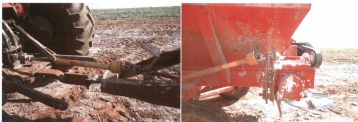
Transmissão de força e a corrente que aciona a esteira transportadora de calcário encontravam-se desprotegidos
