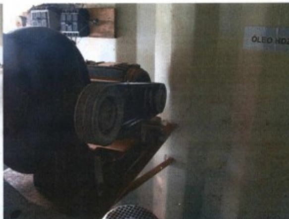
Foto 2- Disco de corte- Polias e correias sem a devida proteção
