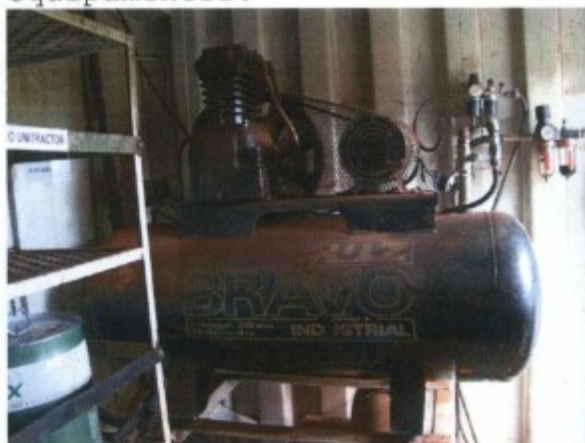
Foto 1- Vaso de Pressão Schulz - modelo Bravo
