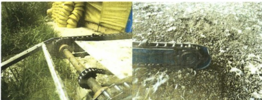
Esteira utilizada para transporte das caixas dos aviários para o caminhão com zonas de perigo desprotegidas
