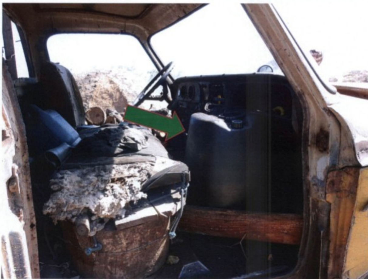
Foto 13 e 14 – caminhão velho usado no transporte de madeira do campo para a carvoaria. No detalhe, tambor usado de forma improvisada como tanque de combustível.
