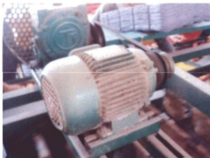
Correia desprotegida de motor na máquina classificadora de maçãs.
