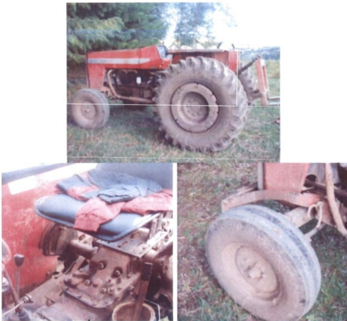
Trator – ausência de proteção contra capotagem
