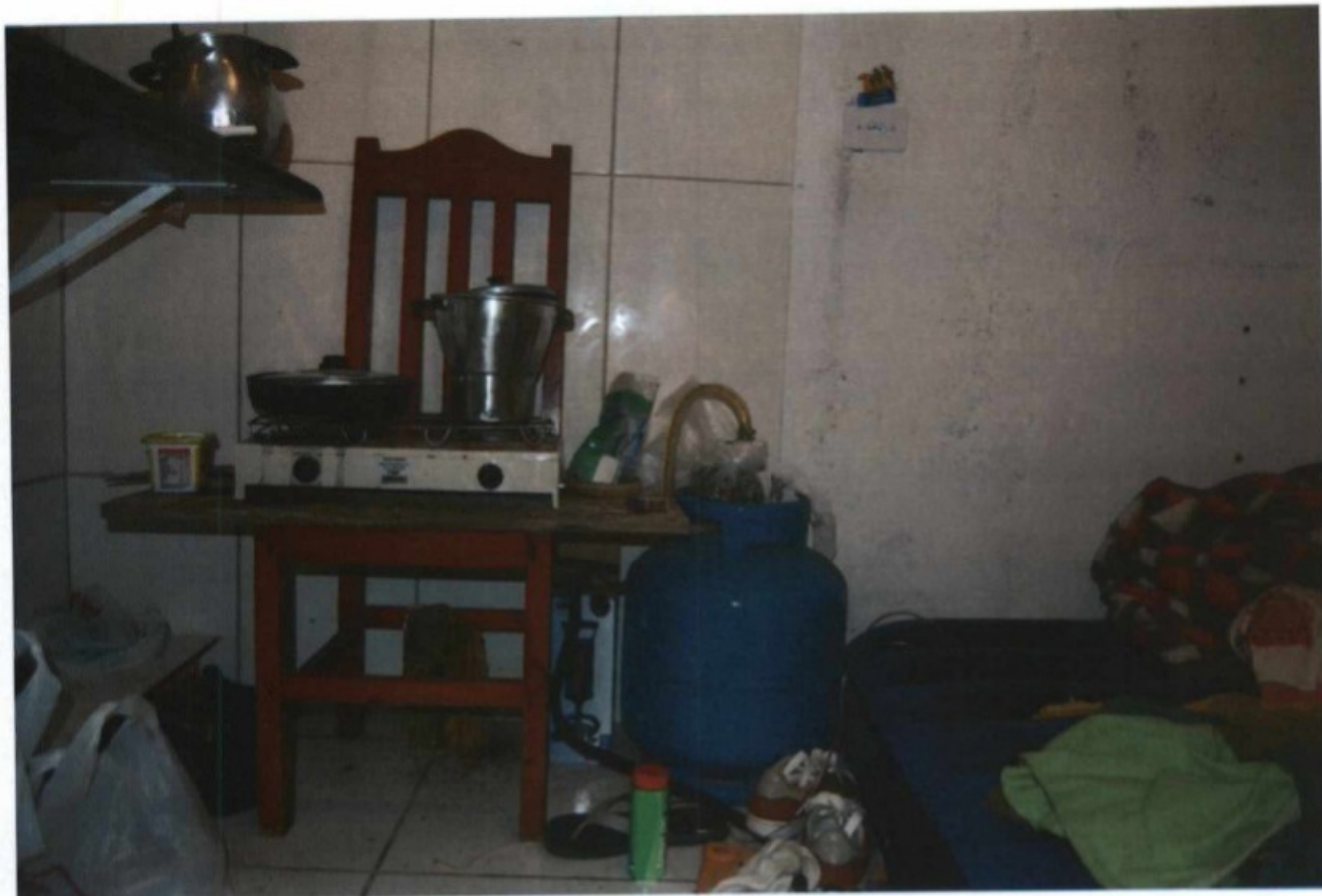
Alojamento situado à [REDACTED] - botijão de gás desprotegido e interno, ao lado do colchonete - risco de explosão
