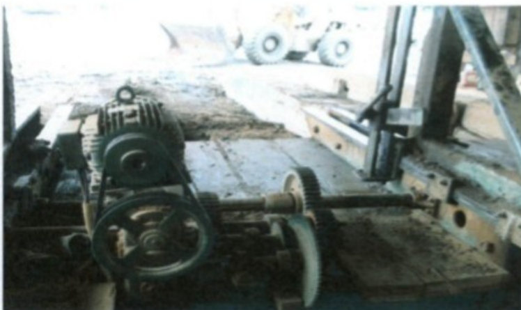
Imagem exhibe transmissão de força acessível e exposta do carro transportador de madeira.
