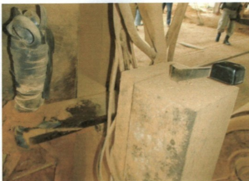
Imagem capturada em 23/02/2013 mostra a chave de óleo utilizada para acionamento e parada da serra fita, e ao seu lado a chave tipo “Lombard”, utilizada para acionamento e parada do carro transportador de madeira. Ambas permitem o acionamento involuntário pelo operador ou por qualquer outro meio acidental.
