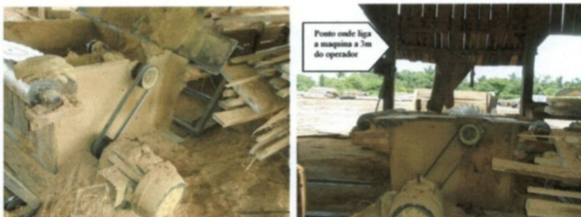
Serra circular para o corte de peças grandes sem proteção de partes móveis, fios soltos e disco sem proteção.
