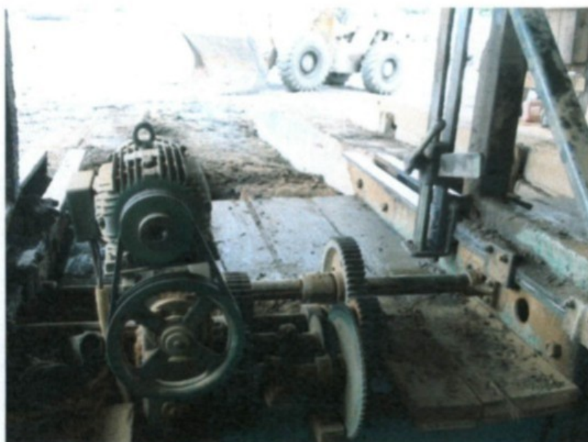
Registro fotográfico feito em 23/02/2013 exibe transmissões de força acessíveis e expostas (polias e correias) do carro transportador de madeira.
