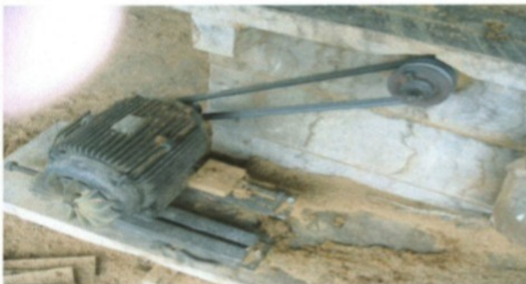
Imagem exhibe transmissão de força acessível e exposta da serra circular.
