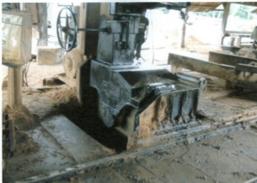
Registro fotográfico produzido em 23/02/2013 exibe a máquina SERRA FITA, na qual pode-se notar abertura no piso usada para realizar a substituição das serras. Observa-se ainda que a zona principal de corte não é dotada de proteção regulável e ajustável ao tamanho da peça.
