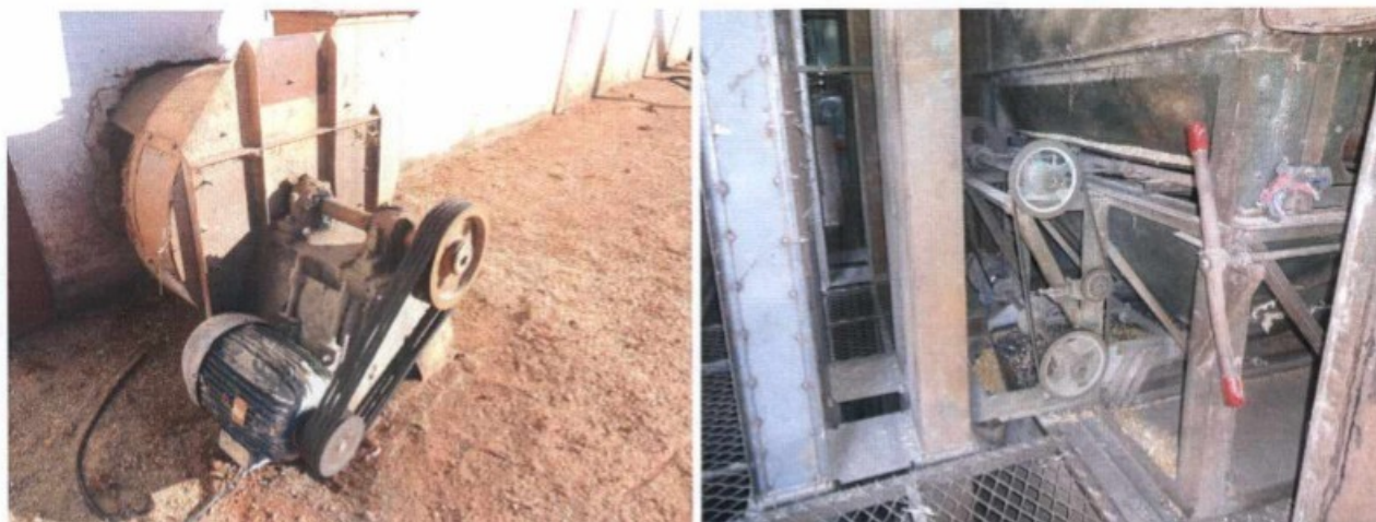
Fotos 9 e 10 - correias e polias sem nenhuma proteção nas referidas transmissões de forças.
