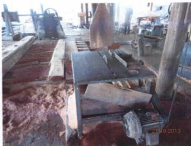
Máquinas com transmissões de força e partes perigosas (serra) desprotegidas
