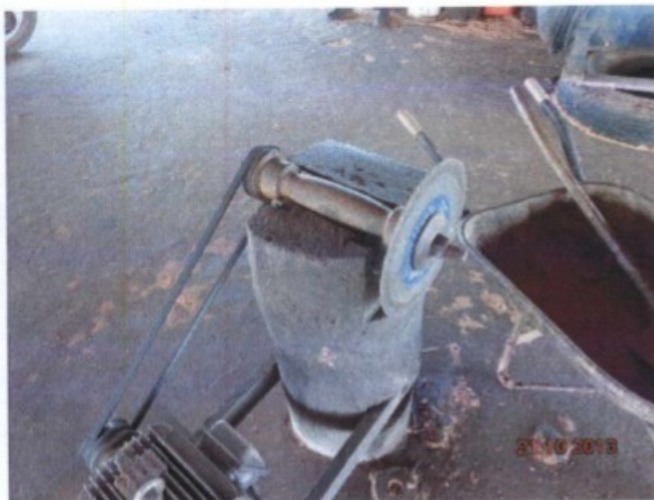
Máquinas com transmissões de força e partes perigosas (serra) desprotegidas
