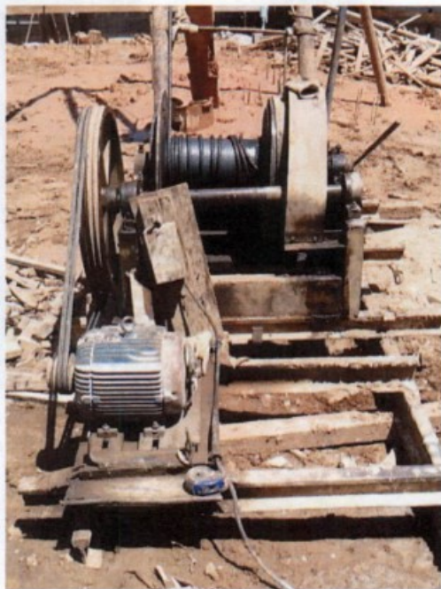
Equipamento utilizado para realização dos serviços de estaqueamento: ausência de proteção nas partes móveis, força de transmissão e motor; ausência, também, de isolamento da área de trabalho.
