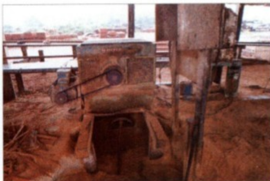
FOTOS: Posto de trabalho do pozeiro. Ao ter que abaixar para retirar o pó de madeira, expunha porções de seu corpo (notadamente, a cabeça) ao risco de serem capturadas pelas transmissões de força (polias e correia) expostas da ribeira.
