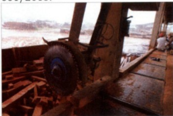
FOTOS: Ausência de proteção completa do disco de corte da estopadeiras (coifa incompleta) e ausência de medidas adicionais adequadas ao tipo de máquina e ao processo de trabalho.
