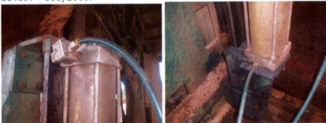
FOTO: Detalhe da conexão sem adoção de qualquer medida adicional de proteção das mangueiras pressurizadas.
