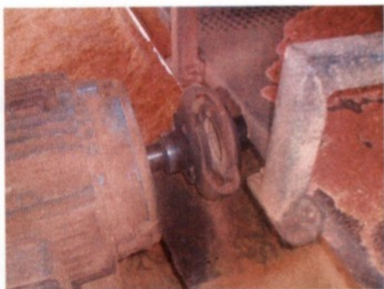
FOTOS: Ausência de qualquer tipo de proteção do acoplamento (transmissão de força) complacente desde a tomada de força no motor até o eixo movido das serras circulares.
