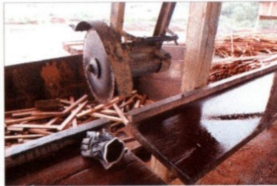
FOTOS: Ausência de proteção completa do disco de corte da estopadeiras (coifa incompleta) e ausência de medidas adicionais adequadas ao tipo de máquina e ao processo de trabalho.
