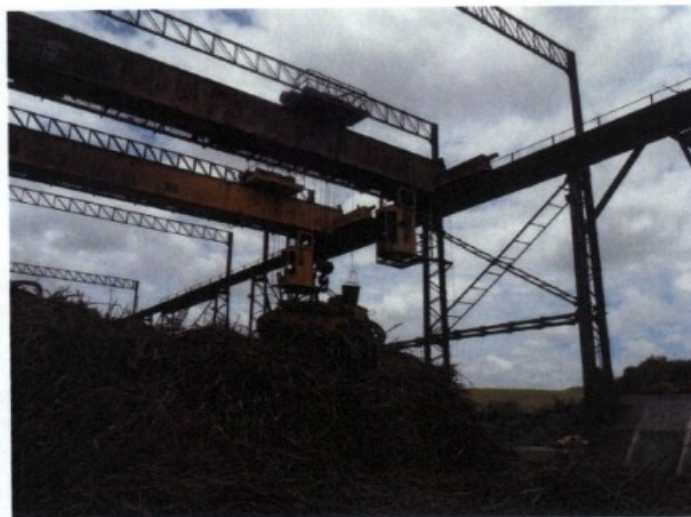
Fig.: Pontes-rolantes em movimentação nos mesmos trilhos com risco de colisão que pode ter consequências graves para os operadores e para os trabalhadores que circulam
