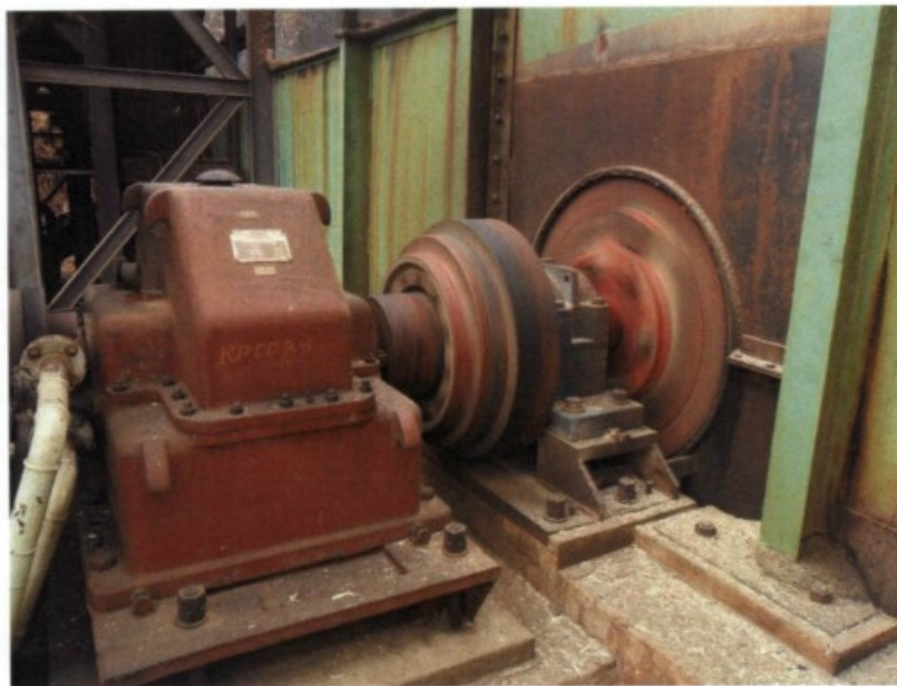
Fig.: Transmissão de força desprotegida.
