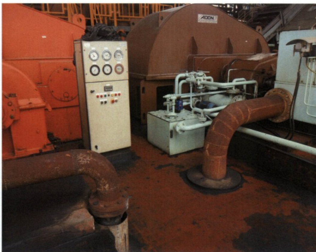
Fig.: Joelhos de tubulação transportando fluidos aquecidos sem proteção contra queimaduras.
