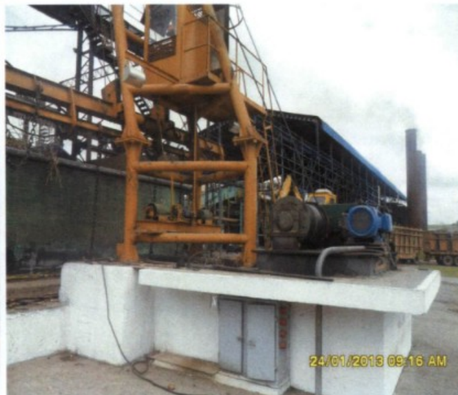
Fig.: Conjunto formado pelo motor, rotor, tambor e cabo de aço do tombador 2 sem proteção contra contatos acidentais de segmentos corporais.
