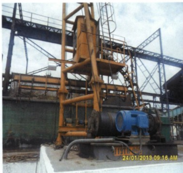
Fig.: Conjunto formado pelo motor, rotor, tambor e cabo de aço do tombador 2 sem proteção contra contatos acidentais de segmentos corporais.
