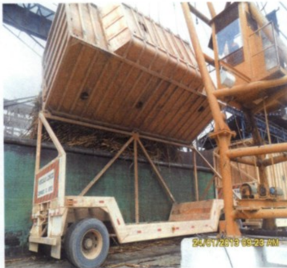
Fig.: Operação de tombamento. Observe que cabine na imagem da esquerda fica exposta ao efeito chicote em caso de rompimento dos cabos ou ganchos. Imagem da direita mostra o auxiliar engatando os ganchos sem garantias do não funcionamento da máquina.
