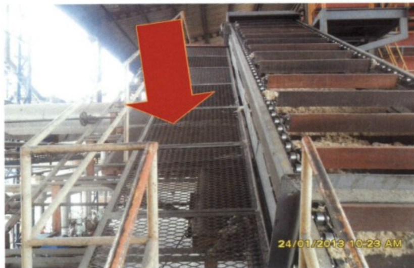
Fig.: Rampa que liga moenda à caldeira sem guarda corpo na lateral direita e ângulo superior a 20 graus.
