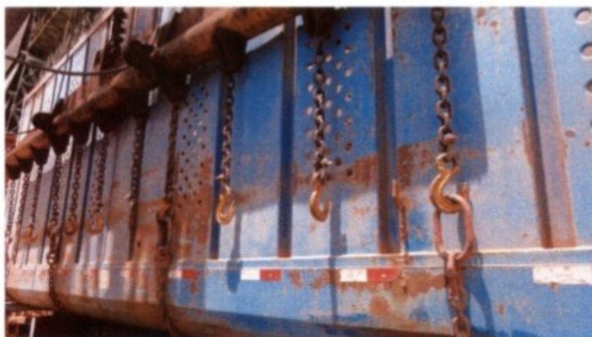
Foto 7. Falta de trava de segurança nos ganchos dos balanços dos hilos;
