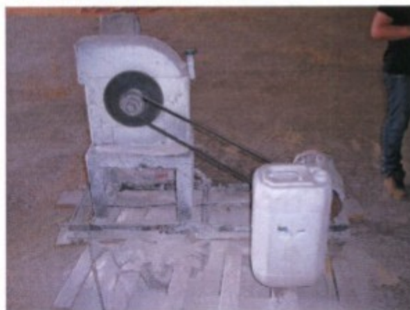
Fotos 8, 9, 10, 11 e 12: tratores e forrageira sendo operados sem dispositivos de segurança exigidos pela NR 31 e NR 12.
