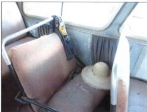
Um dos vários assentos danificados (sem fixação).
