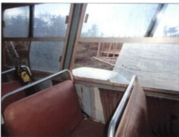
Duas das várias janelas sem vidros, comprometendo a vedação e permitindo a entrada de poeiras.
