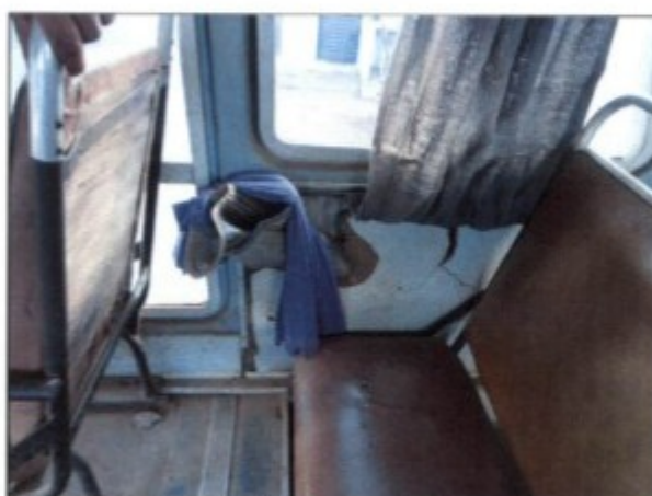
Detalhe do precário estado de conservação do revestimento interno, também comprometendo a vedação.
