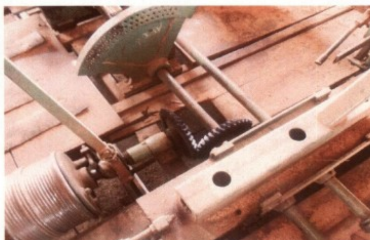
Fig. 11: Transmissões de força do carrinho desprotegidas.
