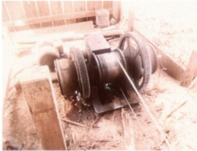
Fig. 1: Avanço do carrinho com transmissões de força desprotegidas.
