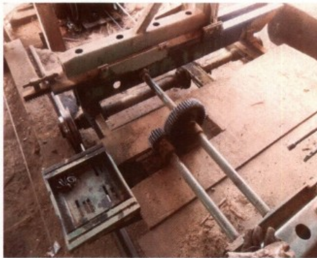
Fig. 1: Carrinho com transmissões de força desprotegidas.
