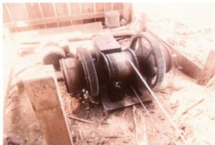
Fig. 12: Avanço do carrinho com transmissões de força desprotegidas.
