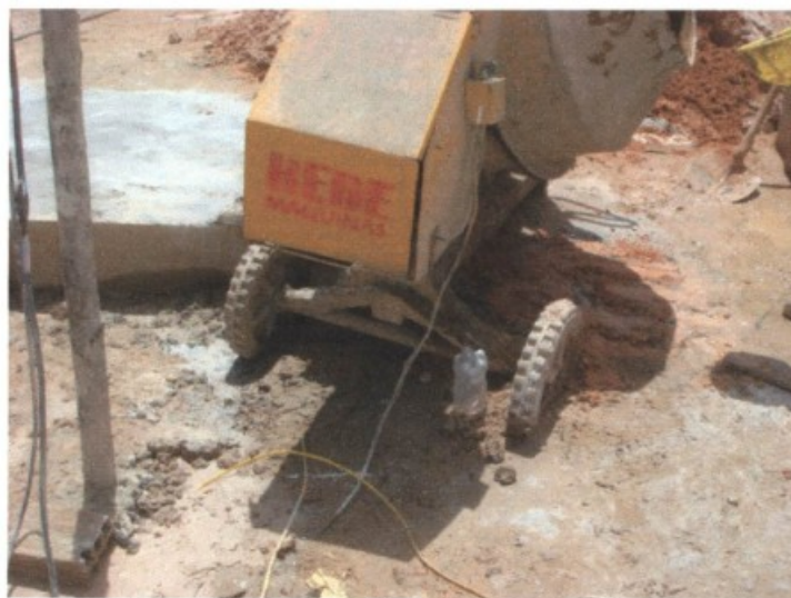
Foto 17-Betoneira sem o aterramento da carcaça.
