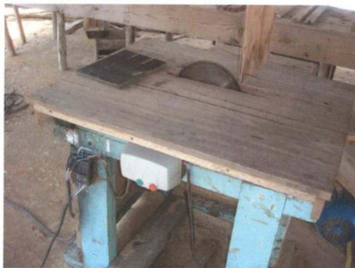
Foto 18-Serra circular com bancada improvisada e desprovida de coifa protetora e cutelo divisor.
