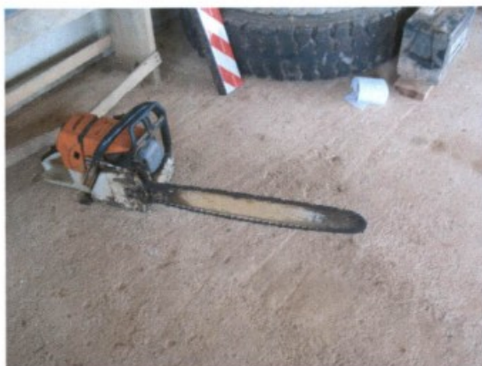
Motosserra interditada pela falta de pino pega corrente.
