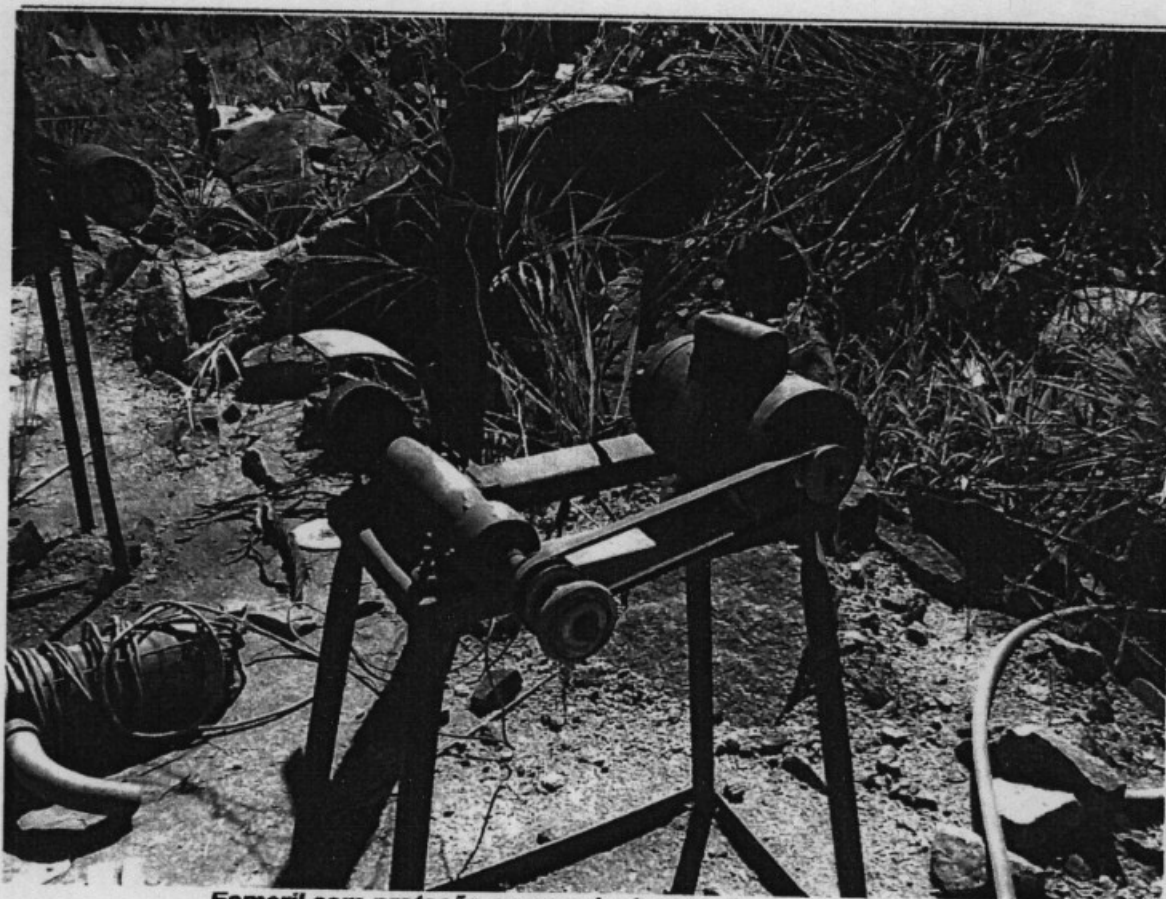
Esmeril sem proteção na correia de rotação
