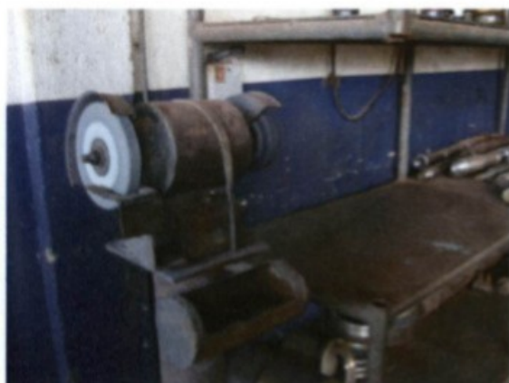
Fotos 31 e 32 – Rebolos do esmeril exposto, sendo acionados por chave reversora e chave tipo pino
