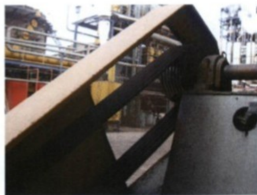
Fotos 16 e 17 - correias e polias das transmissões de força com a proteção incompleta
