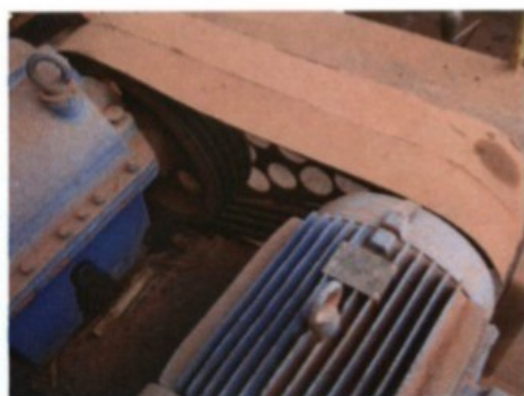
Fotos 16 e 17 - correias e polias das transmissões de força com a proteção incompleta
