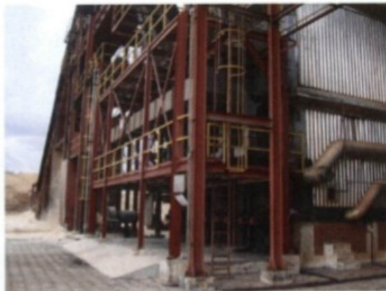
Fotos 18 e 19 - Passarelas sem rodapé – Escadas tipo marinheiro com espaçamento entre as gaiolas e entre as barras maior que o exigido pela NR-12
