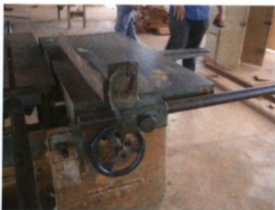
Foto 33 - Serra da esquadrejadeira sem coifa protetora do disco e sem cutelo divisor
