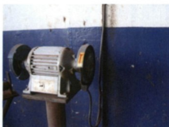
Fotos 31 e 32 – Rebolos do esmeril exposto, sendo acionados por chave reversora e chave tipo pino
