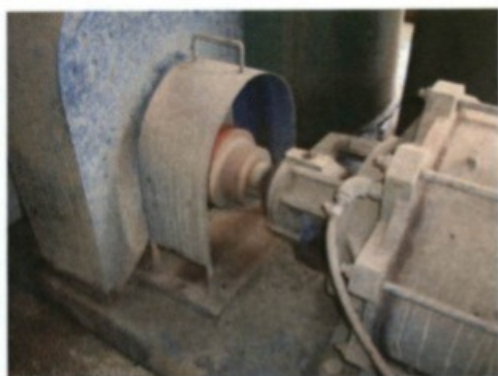
Fotos 13 e 14 - Partes móveis sem proteção
