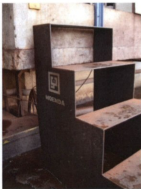
Foto 20 – Escada da moenda sem corrimão
