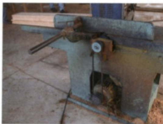
Foto 34 - Correias e polias sem proteção
