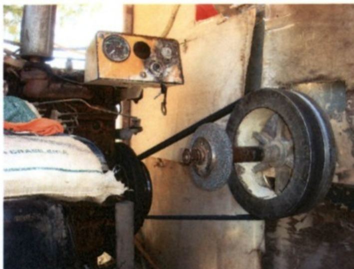
Foto 14-Máquina com a transmissão de força desprotegida.
