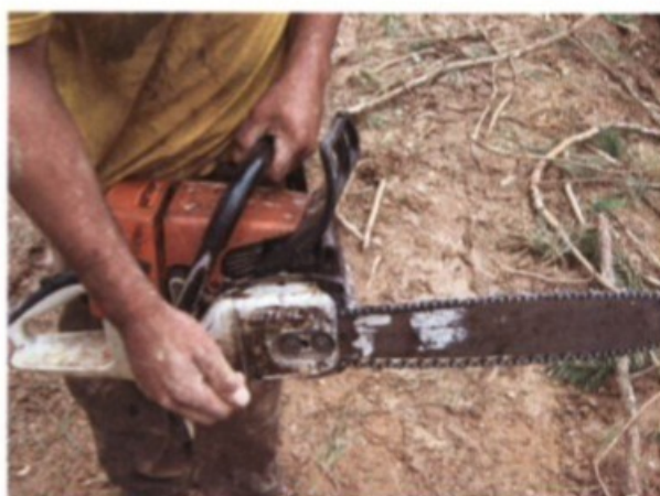
Trabalhadores em atividade de derrubada de pinus. A verificação dos itens de segurança das motosserra.
