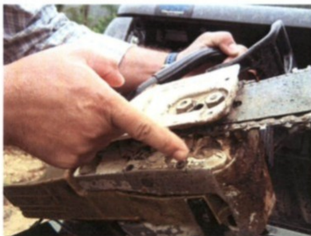
Motosserra sem pino pega-corrente.
