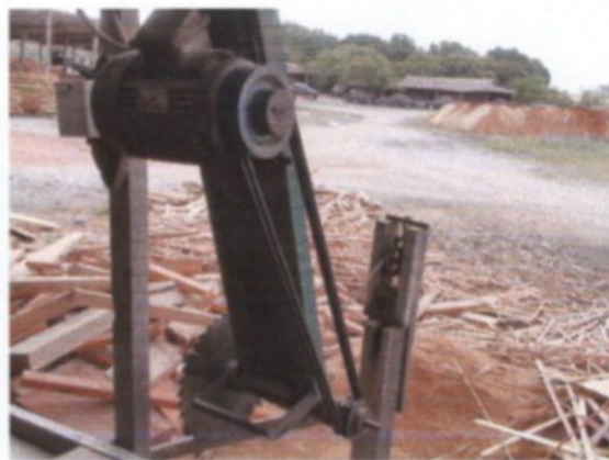
Máquinas sem dispositivos de parada de emergência
