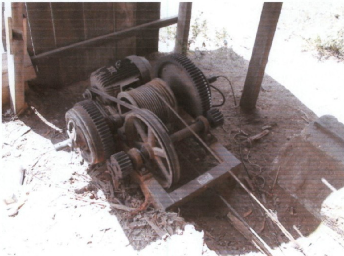
Transmissão de força do carro da serra fita desprotegida.
