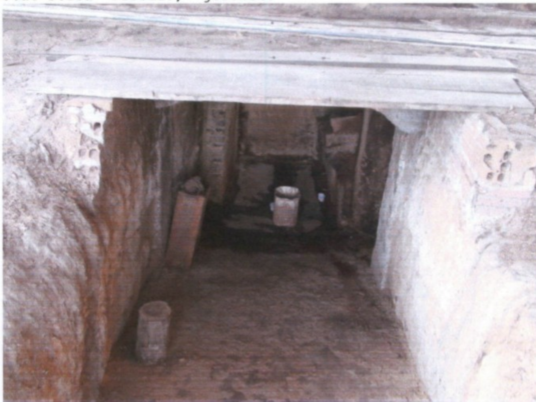
Fosso onde é depositada a serragem que cai da serra-fita, sem guarda-corpo.
