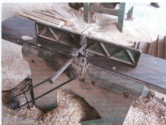
Máquinas sem dispositivos de parada de emergência
